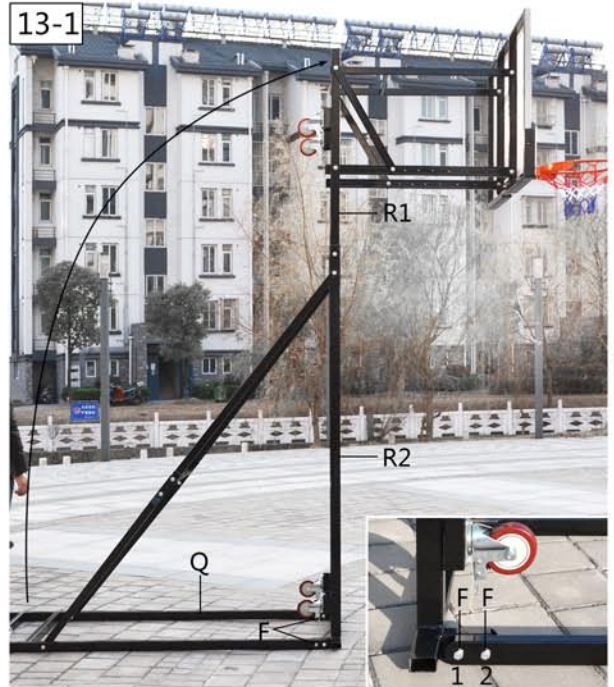
13. Как показано на рис. 13 и 13-1, снимите липучку Y, а затем поднимите нижний основной каркас R2 верхний основной каркас R1. Затем закрепите основание Q на нижнем основном каркасе R2, используя 2 винта F. ВНИМАНИЕ: после окончания шага 13 поросите одного из собирающих встать на основание для безопасности.
